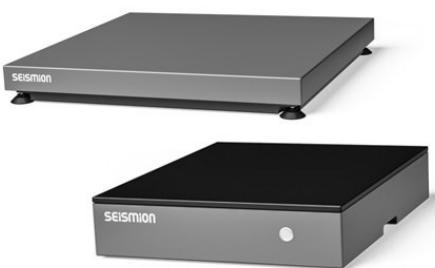
Seismion社製のアクティブ除振台は、高感度のピエゾセンサー、非接触ボイスコイルアクチュエーター、およびノイズと歪みのないアナログ制御回路で設計されており、堅牢な電気的なフィードバック制御によって、特に低周波の振動に対し、優れた性能を発揮し、除振を中断、停止することなく、外乱、振動を処理します。
